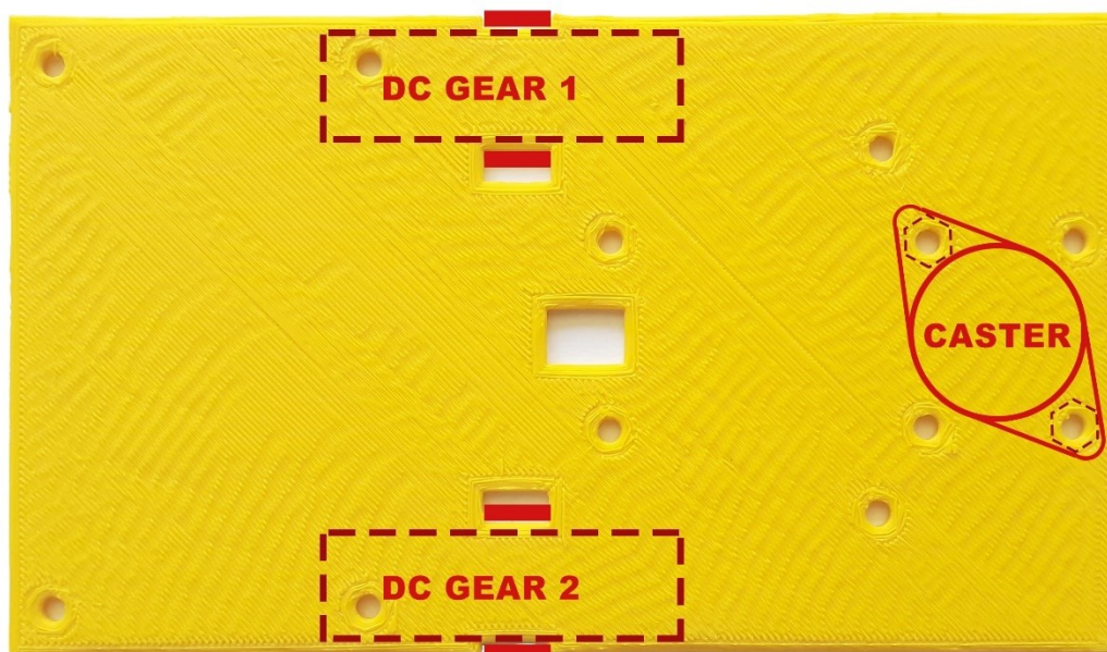
Imagem de 9: Diagrama mostrando onde o rodízio será colocado
