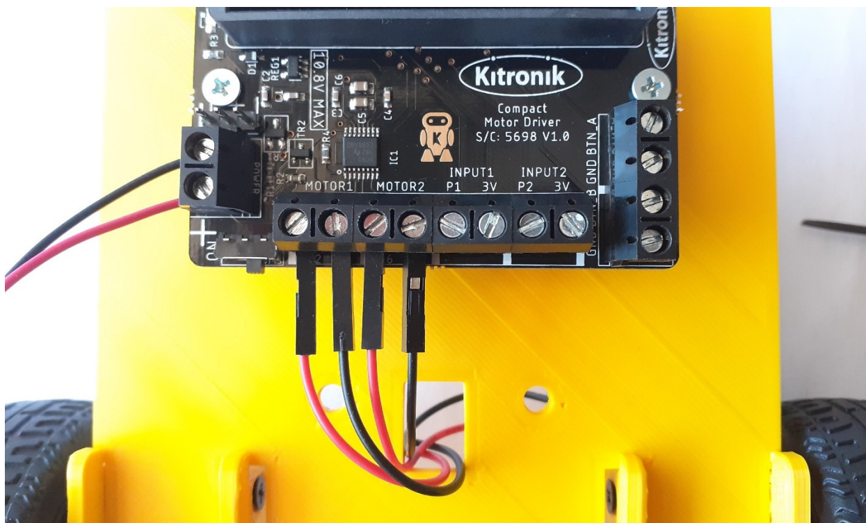
Imagem de 21: Ligação dos 2 motores DC ao driver de motor compacto
