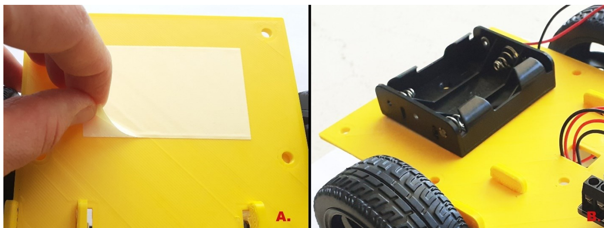
Imagem de 17A. Removendo a parte superior da fita adesiva? B. Colando a caixa da bateria
